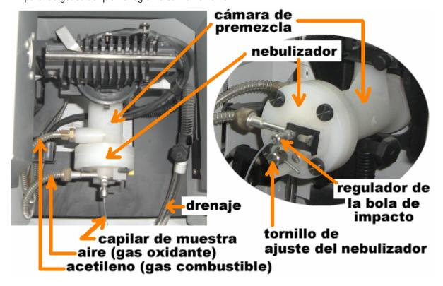
Mechero. Se compone de un generador de chispa (es el que hace clic al pulsar el ignite), un quemador giratorio y un par de tornillos para ajustar la altura y la profundidad del mechero.
