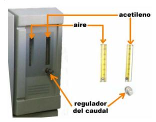
NOTA: la altura que debe alcanzar el centro de la bola en el caudalímetro del acetileno depende del elemento que se esté analizando, tal y como se aprecia en la tabla siguiente.
