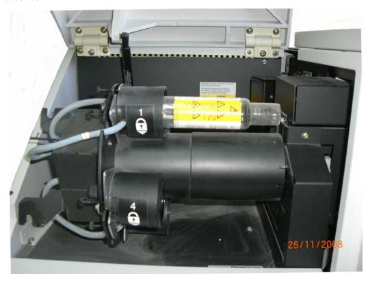
Para introducir la lámpara el portalámparas debe estar en posición abierto, una vez encajada la lámpara girarlo hasta la posición cerrado (indicado en el equipo con un icono de un candado). Girar el revólver hasta que la posición en la que se encuentre la lámpara que vayamos a usar esté en el camino óptico. Las lámparas hay que manipularlas lo menos posible, procurando no tocarlas demasiado y en cualquier caso sujetarlas con un trapito o bien por la zona de la etiqueta.
