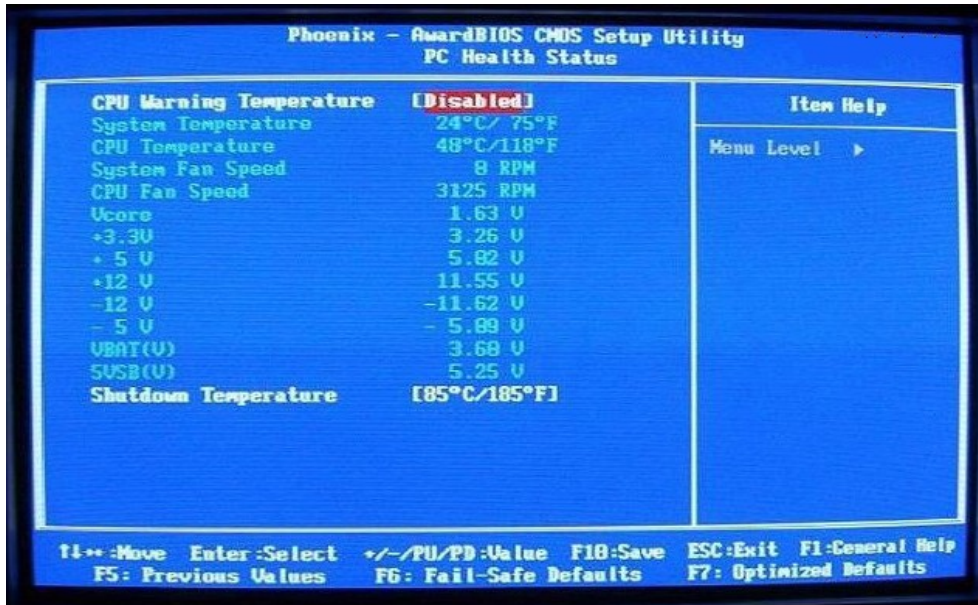
Monitorització de paràmetres elèctrics
