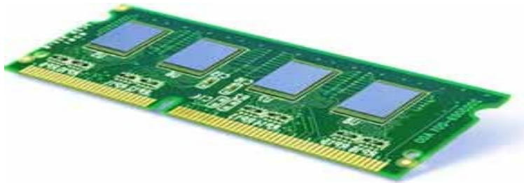
Aspecte d'una DIMM de memòria RAM
