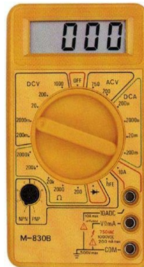
Tester preparat per a la mesura de màxim 2 Volts de corrent continu
