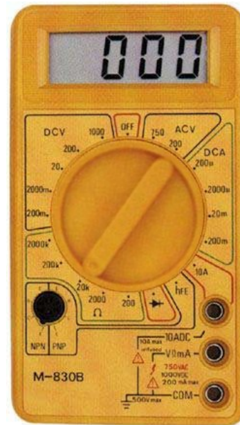
Tester preparat per mesurar una resistència de màxim 20.000 Ohms
