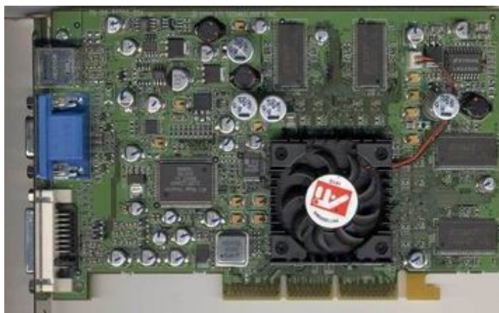
Detall d'una targeta gràfica
