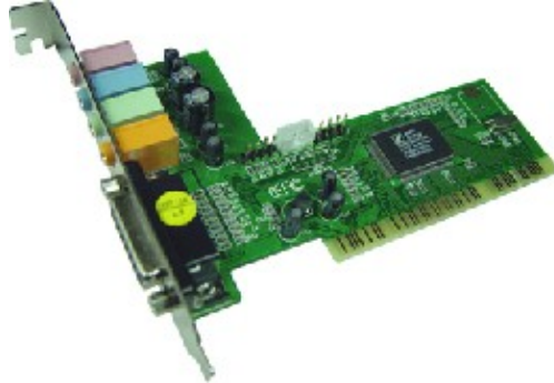
Targeta de so amb unitat de reconeixement de veu
