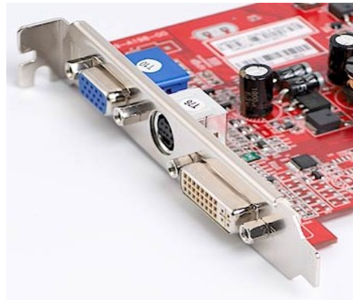
Detall targeta gràfica amb connector VGA i connector DVI
