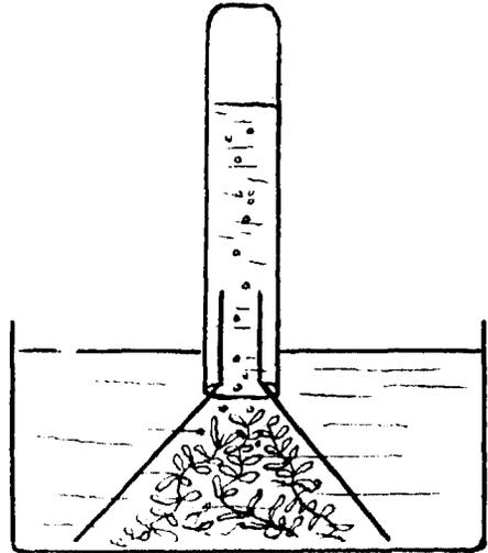
dispuestos como en la figura, para recoger el oxígeno que se va desprendiendo en burbujitas.
