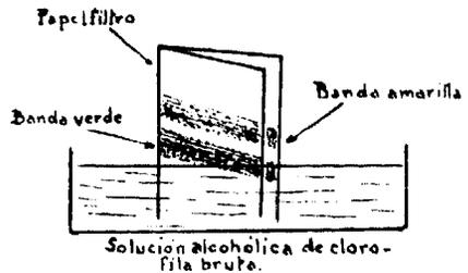
Se pone la solución de clorofila bruta en una cápsula de Petri, y se coloca dentro una tira de papel de filtro doblada como indica la figura. La clorofila y los carotinoides ascienden por capilaridad, pero queda una zona alta adonde sólo llegan los segundos.
