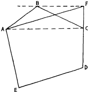
Esta equivalencia se prueba observando que los dos polígonos tienen común el AEDC y que el triángulo ACD del primero se ha sustituido por el ACF en el segundo; y que dichos triángulos son equivalentes por tener la base común, AC, y la misma altura, por ser BF paralela a AC.
