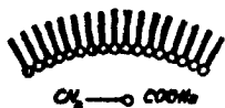
Fig. 5-13. Las moléculas en una pompa de jabón, se disponen unas al lado de otras con los grupos activos COONa (que sienten atracción por el agua) para adentro, y los inactivos CH 2 para afuera.
