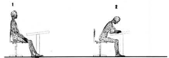
Figura 2. Postures més freqüents a l'escola: quan s'escolta al professor (1) s'acostuma a utilitzar la respallera del seient i s'hi recolza el tronc en una postura més o menys erecta o corbada, mentre que quan es prenen apunts (2) s'acostumen a adoptar postures inclinades endavant, i hom es recolza en el pupitre, taula o escriptori.
