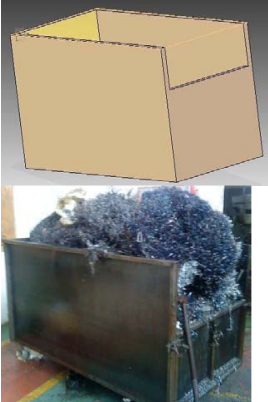
Fig. 6. Ejemplo de contenedor para viruta de hierro, la más numerosa. Realización virtual y real.
