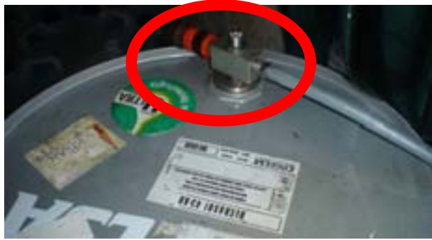
Dosificador de taladrina. Mediante un regulador de efecto Venturi se consigue una concentración exacta.
