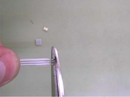
11° Se sueldan los dos cables sobre la palca adaptadora
