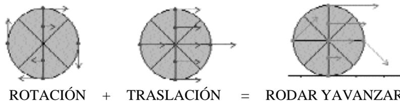
Si nos fijamos en la velocidad de los puntos del diámetro vertical de la rueda respecto a un observador en reposo, tendríamos la siguiente representación:
