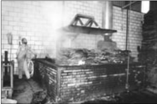
Figura 2.- Cocción de un fardo de corcho en una caldera industrial.
