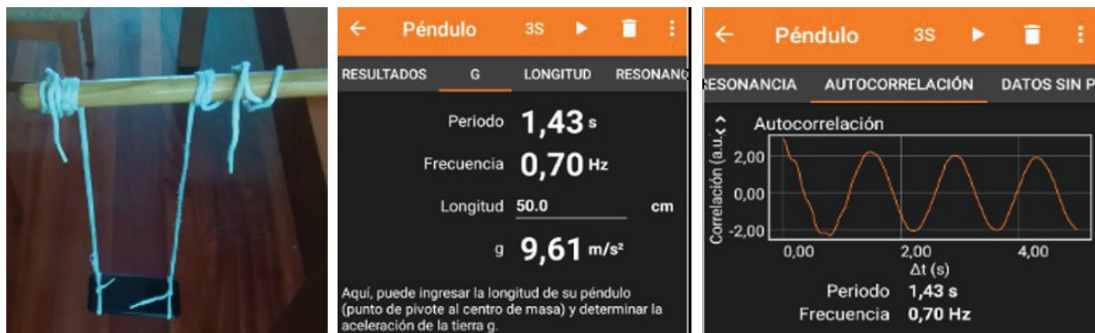
Figura 2. Ejemplo de uno de los montajes realizado por uno de nuestros alumnos. Su propuesta de adaptación versó en estudiar el comportamiento de un péndulo simple utilizando los sensores de su teléfono móvil. En el centro y la derecha, capturas de la pantalla del móvil con los resultados de las mediciones obtenidos con la aplicación Phypox (Phypox, s.f.)
