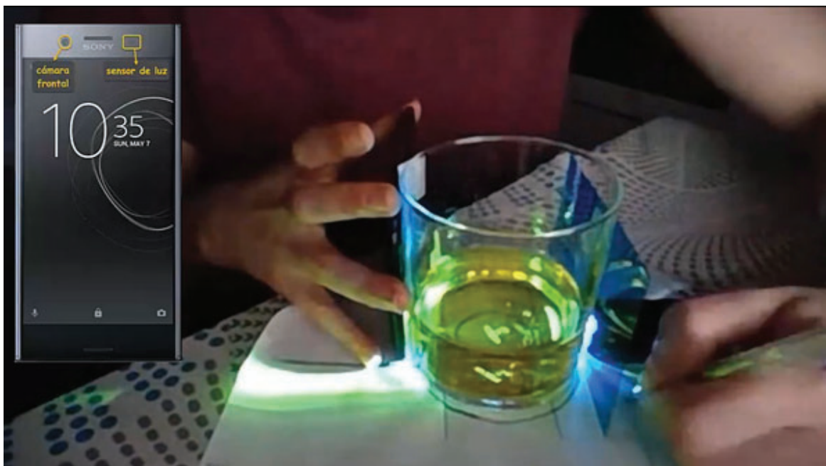
Figura 4. Fotograma del video de la sesión síncrona del taller en el que se muestra cómo se realizaban las medidas y se resolvían dudas sobre la posición del sensor de luminosidad del smartphone .
