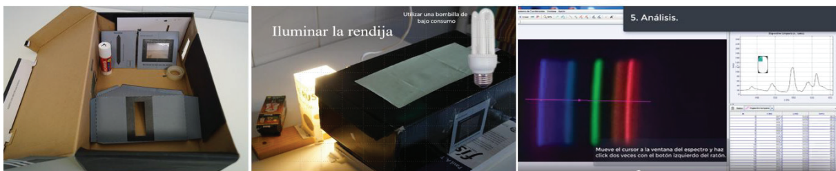
Figura 1. Detalles del material de apoyo para la construcción de un espectroscopio. A la izquierda, la caja con los elementos necesarios para montar el instrumento. En el centro, detalle que ilustra cómo obtener el espectro de una lámpara de bajo consumo. A la derecha, fotograma del videotutorial donde se explica cómo utilizar las líneas del espectro para obtener el espectro completo de emisión de la lámpara.
