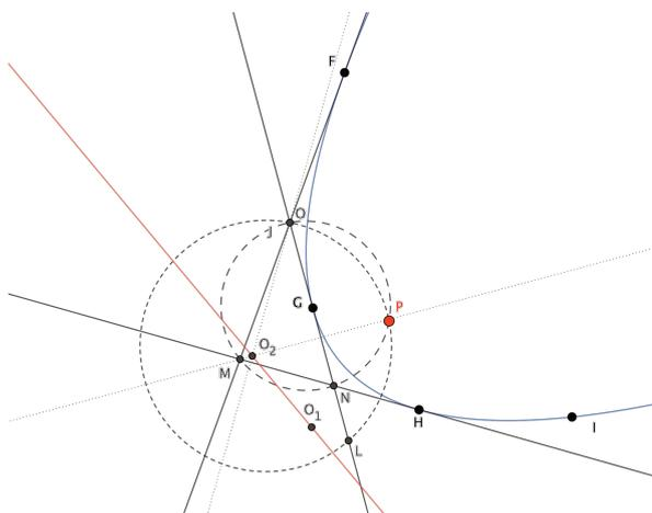
Figura 20. Aplicación del teorema de Lambert
