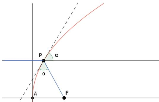
Figura 15. Ángulos determinados por la tangente en la parábola
