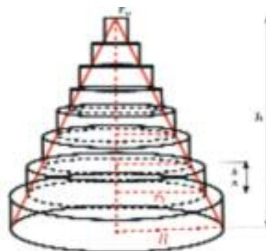
Figura 3. Un cono aproximado exteriormente por cilindros
