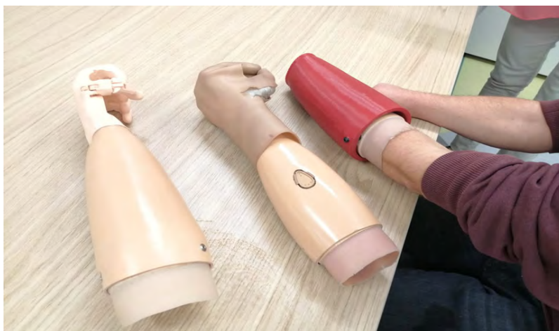
Figura 10. Prótesis mioeléctrica, mano fabricada por Ayúdame3D y nuevo material en prueba
