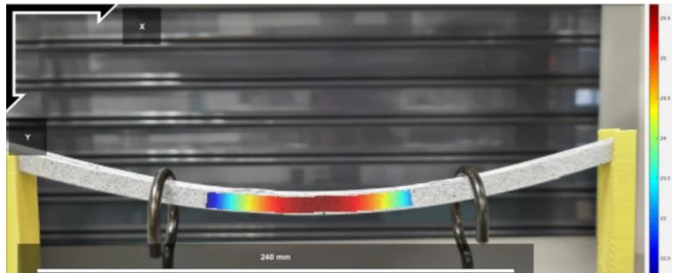
Figura 5. Imagen obtenida con Ncorr de los desplazamientos verticales v medidos en la viga cargada.
