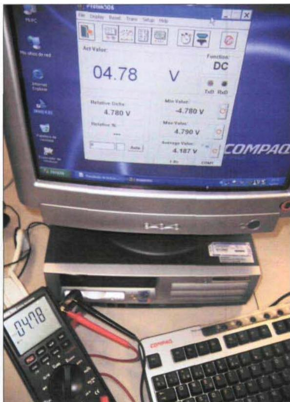
**Figura 3.** Lectura de medidas mediante la conexión de polímetro con PC y Software adaptado
