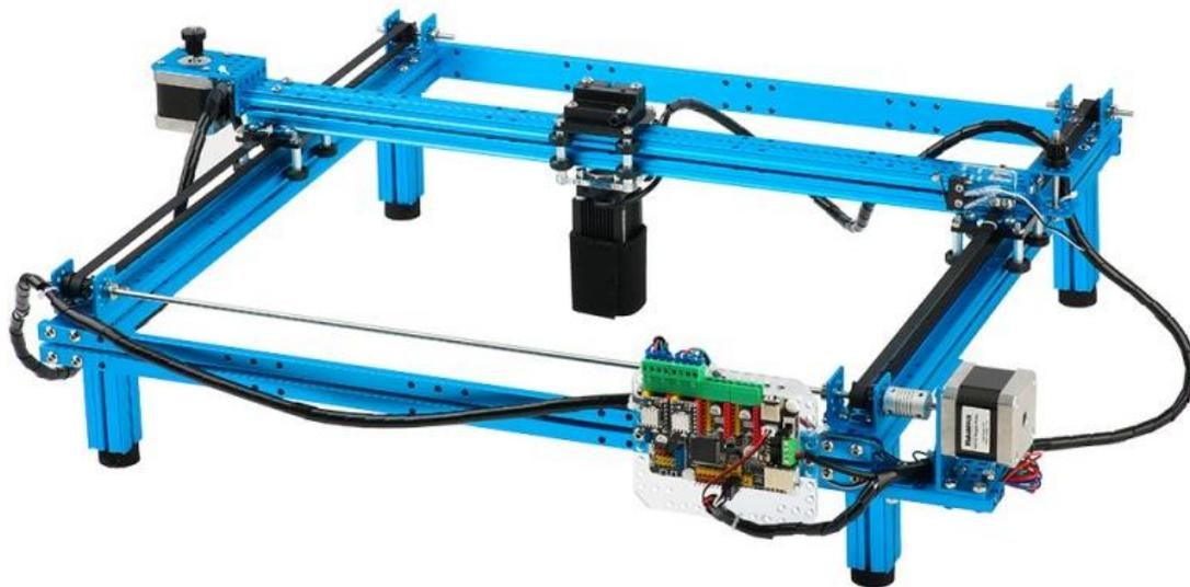
Figura 11. Kit de cortadora láser ligera montado. Fuente: [www.makeblock.es](http://www.makeblock.es)
