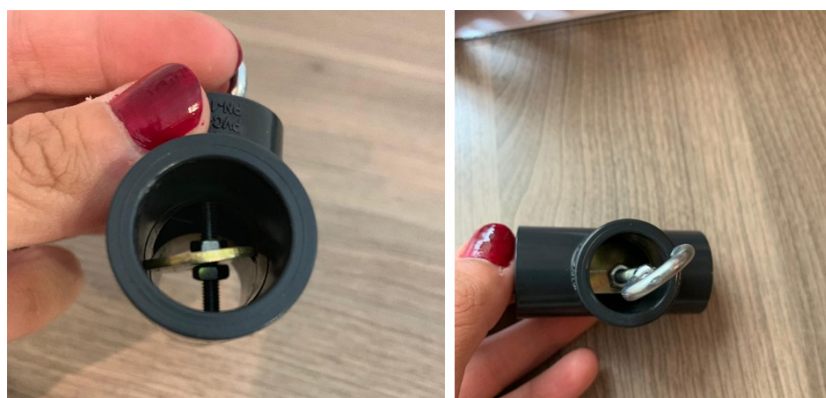
Figura 10. T de PVC con el cáncamo colocado
