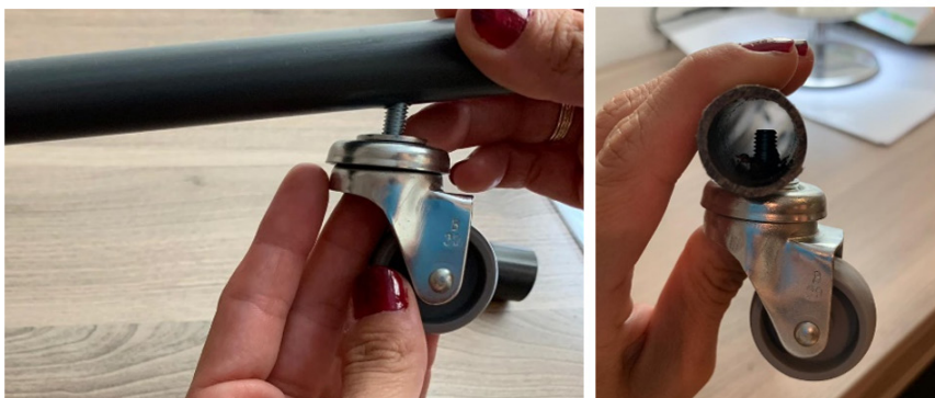
Figura 12. Imágenes del tubo sujetando la rueda dentro del mismo
