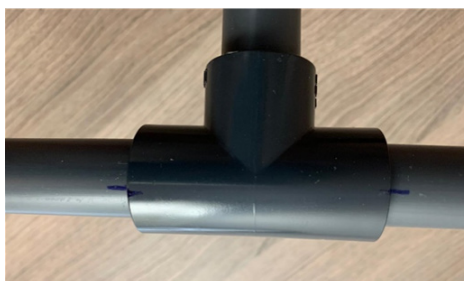
Figura 14. Tubo con las marcas para el pegado final
