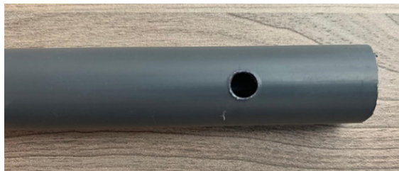
Figura 11. Tubo de PVC con el agujero realizado para la consiguiente colocación de la rueda
