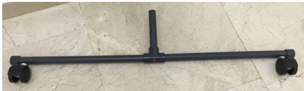
Figura 2. Adaptador inicial creado: barra más ancha en forma de T con ruedas giratorias
