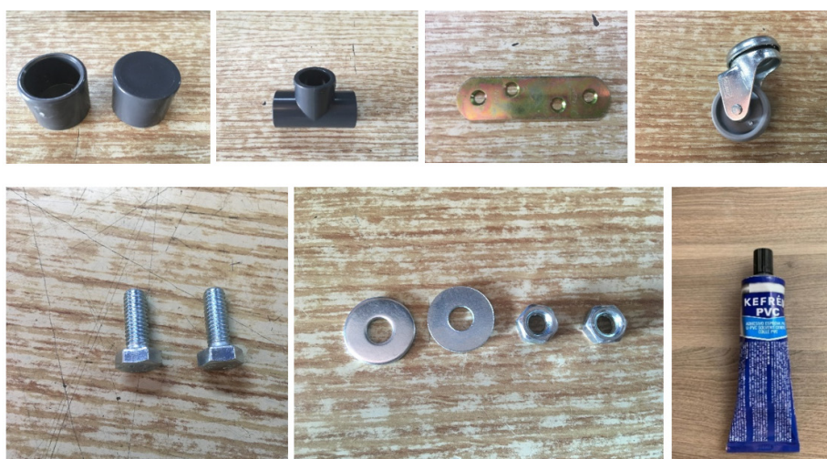
Figura 9. Tapones y T de PVC, chapa alargada, rueda giratoria, tornillos, arandelas y pegamento empleado
