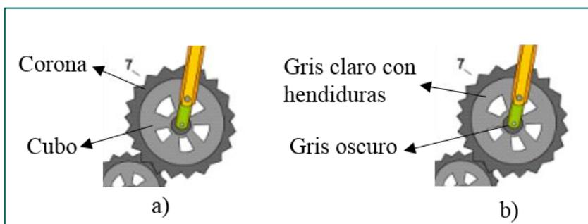
Figura 6. Partes de la rueda conductora.
