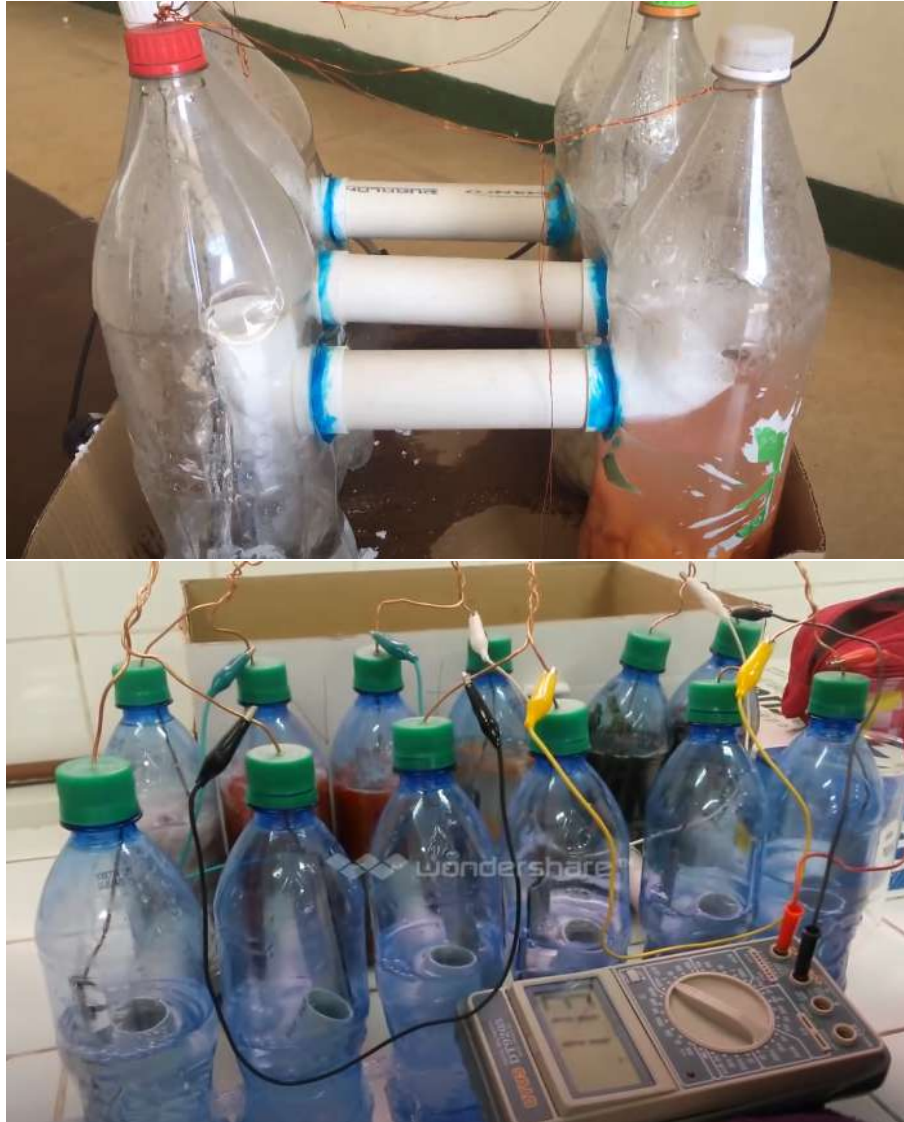
Figura B.2: Celda de combustible microbiana con materiales sencillos. ( Celda de combustible microbiana , 2020; Generación de energía eléctrica a partir de biomasa. , 2020)
