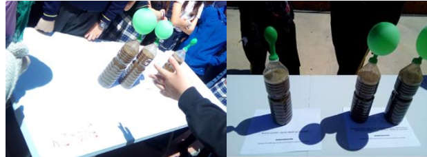
Figura 7. Experiencia 1. Producción de energía renovable a partir de residuos orgánicos.
