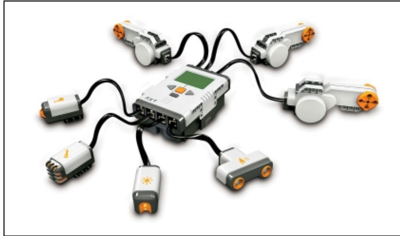
Figura 5: Bloque NXT, sensores y actuadores.
