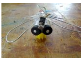
Ejemplos de Vibrobot y robot fotosensible
