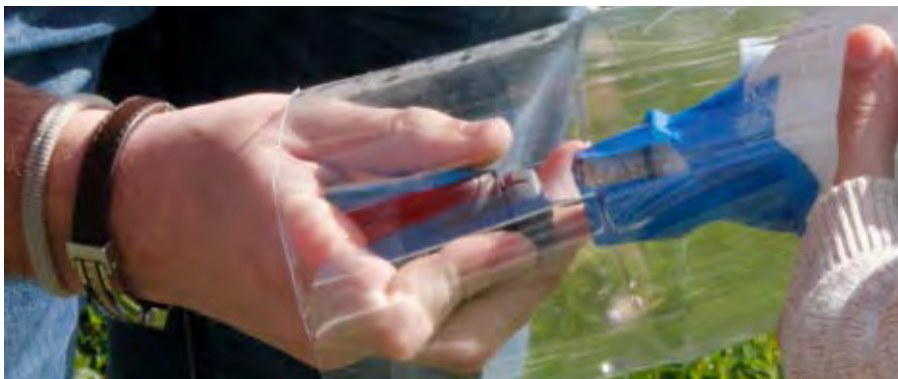
Figura 6: Corcho atravesado por una válvula para introducir el aire con una bomba de bicicleta.
