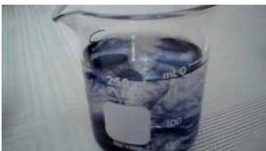
En un vaso de precipitados que contiene una disolución de yodato de potasio con almidón, se añade otra disolución de hidrogenosulfito de sodio. Con el cronómetro se mide el tiempo que transcurre desde la mezcla de las disoluciones hasta la aparición de un color azul violeta. En vasos diferentes, se repite el ensayo, pero a las
