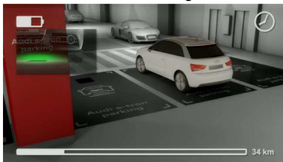
Figura 3.11: Vídeo sobre recarga de baterías de coches eléctricos mediante inducción magnética. (Recuperado el 18 de marzo de 2015 de https://www.youtube.com/watch?t=84&v=5LX0XI6ISLg ).
