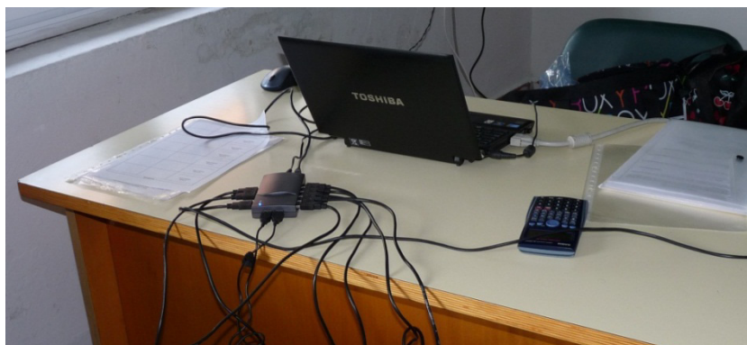
Imagen 7. Concentrador USB de 13 puertos con alimentación, utilizado en la innovación
