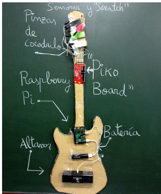
Figura 4. Guitarra programable con Scratch.
