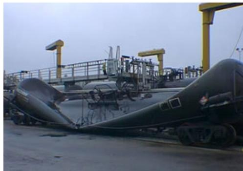
**Imagen 19.** Implsión de depósito cilíndrico. Fuente: YouTube.
