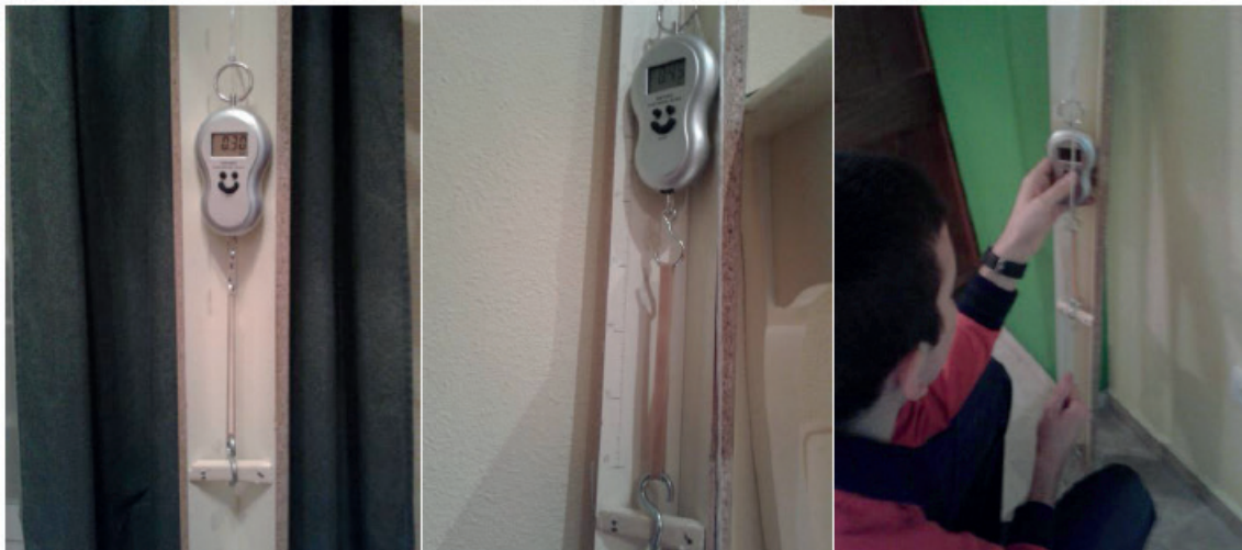
Figura 12. Metodología de medida presentada por uno de los grupos. Medida de la carga aplicada y de la deformación.
