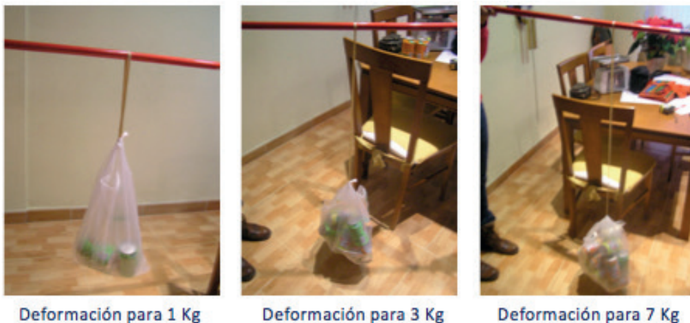
Figura 9. Metodología de medida presentada por uno de los grupos. Toma de medidas para diferentes estados de carga.
