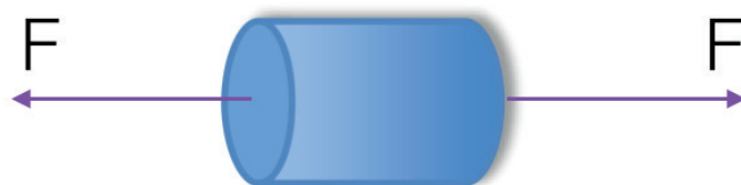
Figura 7. Aplicación de una carga de tracción sobre probeta cilíndrica.
